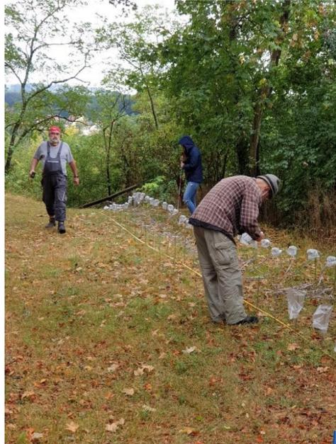
Abbildung 5: Ausstecken der Elektroden
