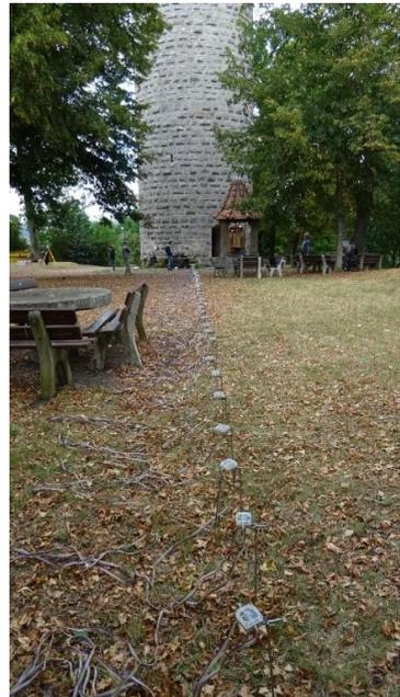
*Abbildung 1: Anordnung eines Messprofils mit verkabelten Elektroden südlich des Bergfrieds*
